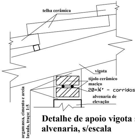
Detalhe de apoio vigota sobre alvenaria, s/escala
